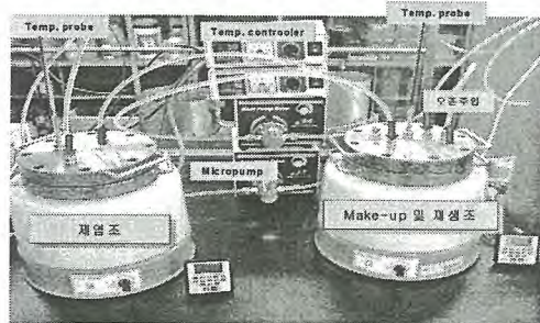
Fig. 1. 황산-세럼 제염 실험 장치.
