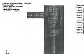
Fig. 5. 단순화된 금속 CASK와 엔진 missile의 충돌 해석 (coupled)
