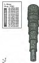
그림 2. 텔레스코픽 튜브셋의 구조해석 결과
